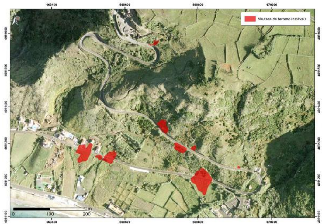
Localização das massas de terreno instabilizadas na Praia Formosa, abrangidas pelas redes de Monitorização (Fonte: Figura 3 do DTC 01/IVAR/CIVISA/25)
