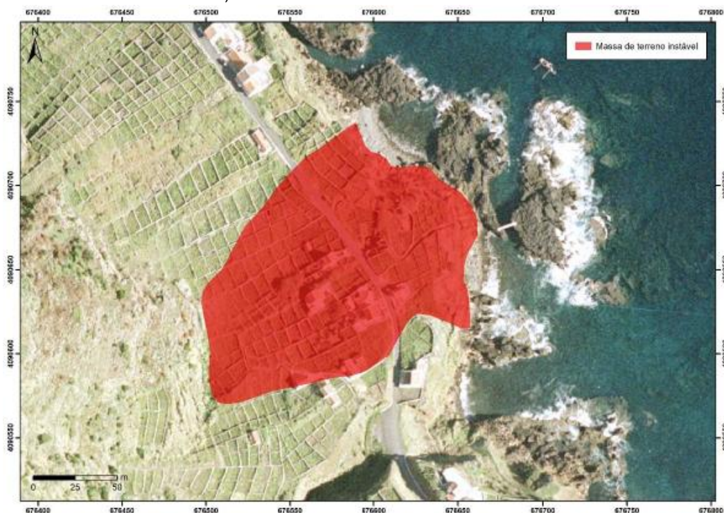
Localização da massa de terreno instabilizada na Maia, abrangida pelas redes de monitorização (Fonte: Figura 2 do DTC 01/IVAR/CIVISA/25)
